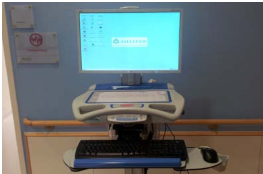
Mobiles Arbeitsplatzsystem von Rubbermaid: Auch dieser Desktop wird über die zentrale XenDesktop-Umgebung zur Verfügung gestellt.
